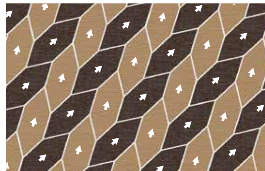
Pose de prismes réalisée avec deux coloris.
