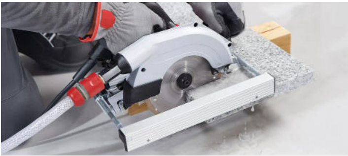
Moteur à haut rendement : ultra-puissant, pour la découpe dans la pierre et le fraisage de joints
